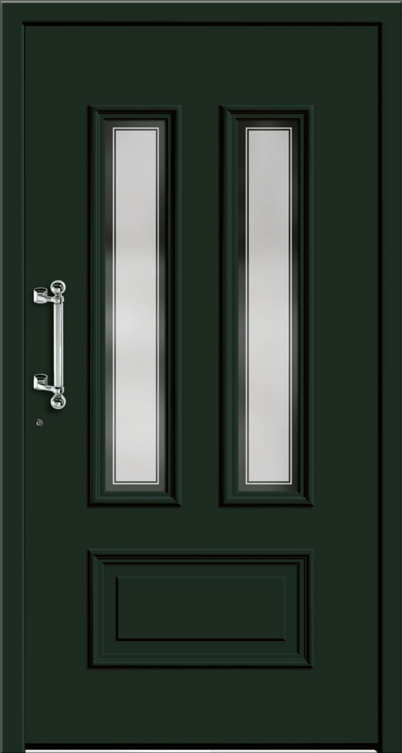
Nembus 20 FA+ Rahmen aufgesetzt (RA) | Farbe: RAL 6009 Tannengrün Glas: G 1200 mattiertes Glas mit klarem Rand und klarem Streifen | 0,7 W/m²K Griff: GAC 10, 330 mm Chrom Innenansicht: mit aufgesetztem Rahmen in Deckschichtfarbe, ohne Kassette
