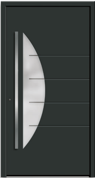
Sirius 20 FA+ Proflierung außen | Farbe: RAL 7016 Anthrazitgrau | Glas: G 1446 mattiertes Glas mit klaren Streifen | 0,7 W/m²K Griff: GAE 5, 1400 mm Edelstahl Innenansicht: mit Flachrahmen in Deckschichtfarbe
