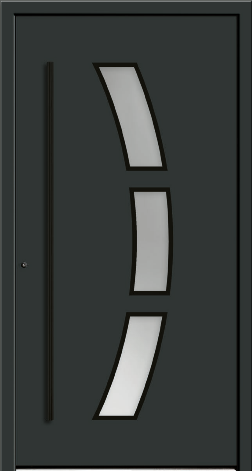
Musika RSF FA+ Rahmen Schwarzstahloptik flächenbündig (RSF) Farbe: RAL 7016 Anthrazitgrau Glas: satiniertes Glas | 0,7 W/m²K Griff: GAS 3, 1600 mm schwarz Innenansicht: mit Flachrahmen in Deckschichtfarbe
