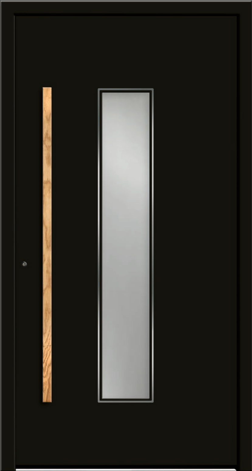
Rhea 10 LEU FA+ Lisene Edelstahloptik umlaufend (LEU) Farbe: RAL 9005 Tiefschwarz Glas: satinierendes Glas | 0,7 W/m²K Griff: GAHS 8, 1400 mm Eiche / Konsole schwarz Innenansicht: mit Flachrahmen in Deckschichtfarbe Dieses Modell ist auch mit umlaufender Lisene in Schwarzhloptik (LSU) lieferbar.
