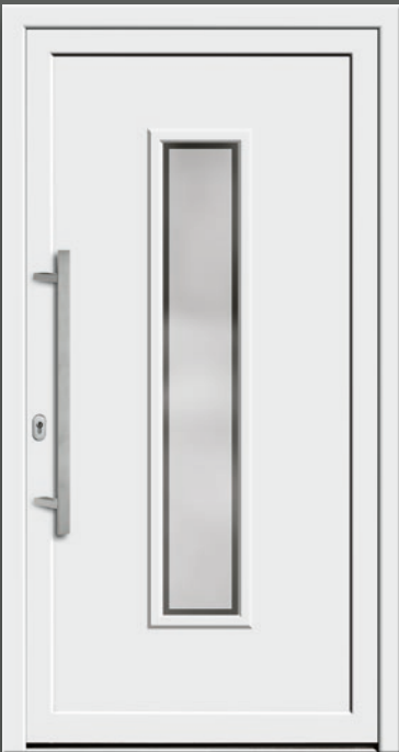
Rhea 10 RA E Rahmen aufgesetzt (RA) Farbe: RAL 9016 Verkehrsweiß Glas: G 500-25 mattiertes Glas mit klarem Rand | 0,7 W/m²K Griff: GAE 2, 800 mm Edelstahl Innenansicht: mit Flachrahmen in Deckschichtfarbe
