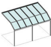
Pultdach mit Solarknick
