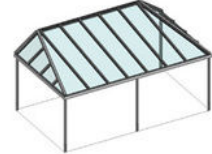
Pultdach, seitlich abgewalmt
